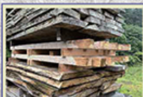
積み重ねてある程度の乾燥をさせます。
