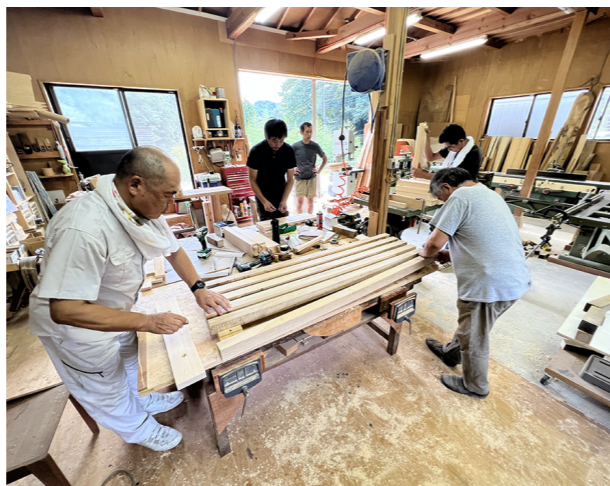
コナラは座面の角材 脚部分は、西川ヒノキ材を防腐処理
