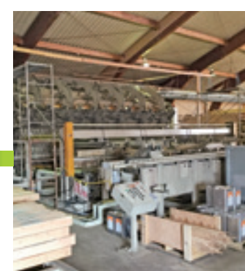
油圧式回転プレスが自動で圧力管理を行い適正圧力を保ちます。
