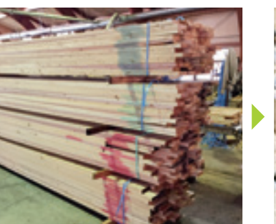
測定されたラミナは強度等級毎に異なる色が付けられ識別します。
