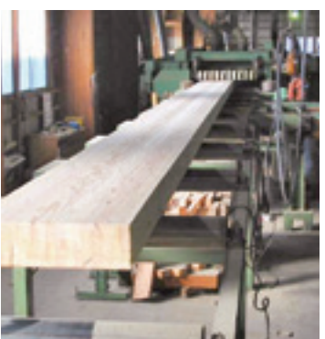
6軸モルダで4面仕上げます。
