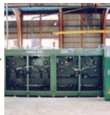
グレーティングマシンによりラミナの曲げヤング係数を全数測定し強度等級区分を実施。
