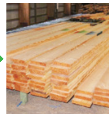
測定されたラミナは強度等級毎に異なる色が付けられ識別します。
