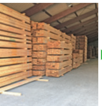
人工乾燥後の挽き板を倉庫内で外気となじませ内部応力を緩和させます。
