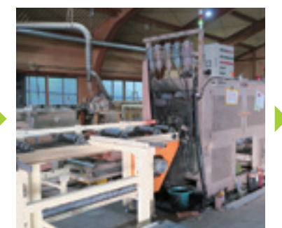
グレーティングマシンによりラミナの曲げヤング係数を全数測定し強度等級区分を実施。
