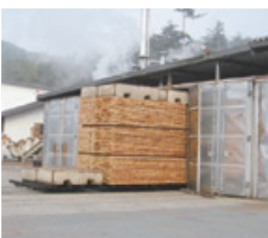
人工乾燥機 高温蒸気式脱脂乾燥。蒸気ハイオマスボイラー利用。月産乾燥能力 700m 3 。
