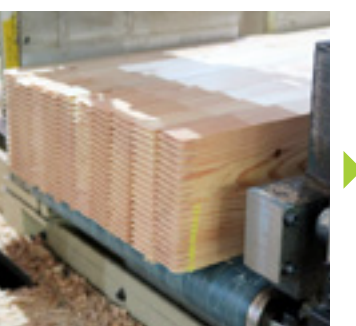
フィンガージョイント(縦接ぎ)を行い集成材に必要な長さのラミナにします。
