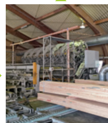
水性高分子イソシアネート系樹脂接着剤を塗布します。
