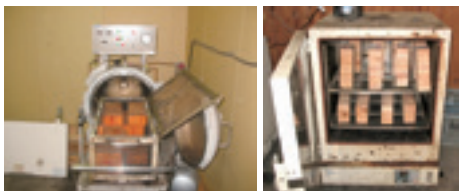
減圧と加圧を繰り返し、強制的に集成材に水を注入した後、乾燥機で元の質量になるまで乾燥させ、その時に接着層に剥離が無いことを確認します。
