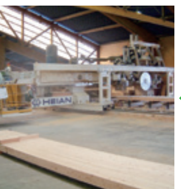
CAD/CAM対応のCNCマシンにより高精度に加工します。
