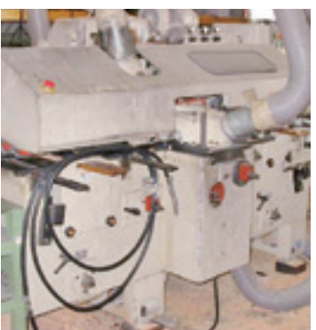
ラミナの表面をモルダで荒削りし水分センサーラインへ投入。
