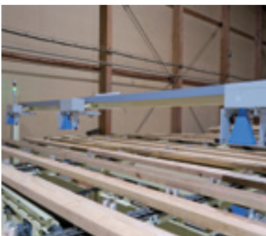
マイクロ波水分センサーでラミナ全数の合否判定を実施。
