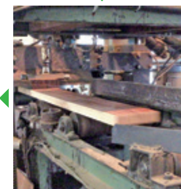
モルダにてラミナ表面を仕上げ後レゾルシノール・フェノール樹脂接着剤を塗布します。
