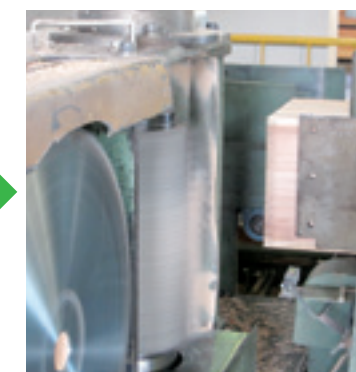
フィンガージョイント(縦接ぎ)を行い集成材に必要な長さのラミナにします。
