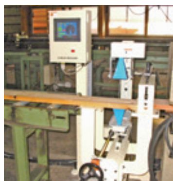
マイクロ波水分センサーでラミナの含水率の合否判定を全数実施。
