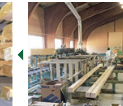
4軸モルダで4面仕上げ切削。
